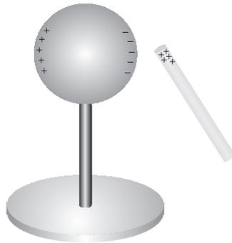
Figura 1.3: Corpo carregado próximo a condutor
